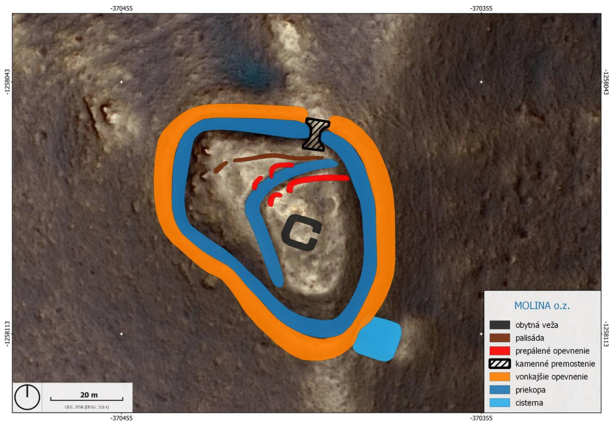
Obr. 6: Interpretácia nameraných údajov z magnetometrie na podklade LLS snímku (zdroj produktov LLS: ÚGKK SR, vizualizácia dát LLS: T. Lieskovský, súr. systém S-JTSK, EPSG: 5514).
